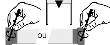
Tournez la vis de la tête moteur (sens de rotation -) correspondant à la butée haute ↓. Pour voir le résultat, appuyez sur la touche descente pour descendre le tablier, puis la touche montée. Recommencez si nécessaire.
