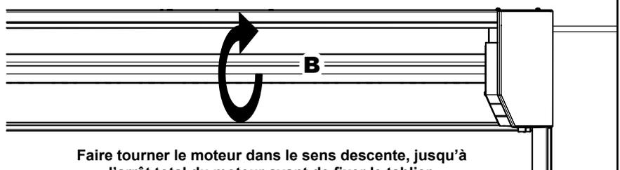
Faire tourner le moteur dans le sens descente, jusqu'à l'arrêt total du moteur avant de fixer le tablier.
