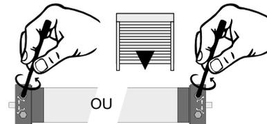
Tournez la vis de la tête moteur (sens de rotation +) correspondant à la butée basse ↑ jusqu'à la position souhaitée.
