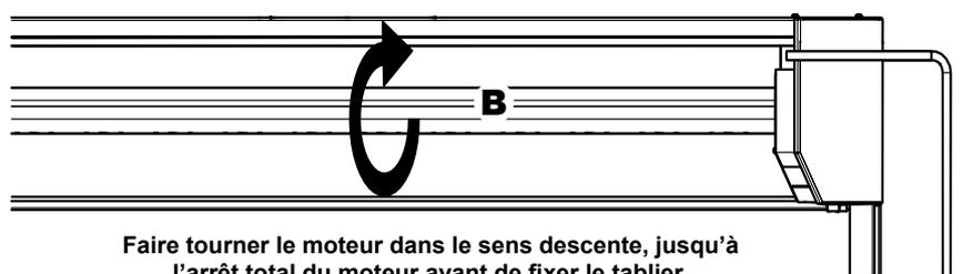
Faire tourner le moteur dans le sens descente, jusqu'à l'arrêt total du moteur avant de fixer le tablier.
